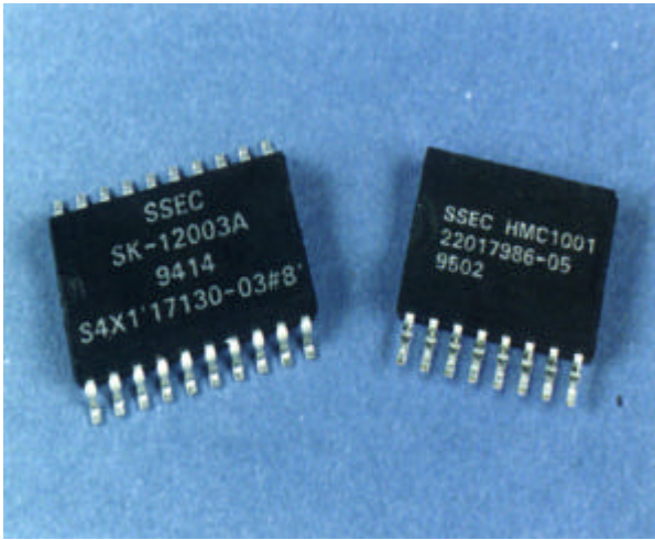
图7.MR传感器为异态检测提供高灵敏度和特的解方法，根据物体的磁性信号特征物识别。
